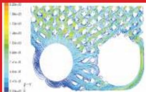
Моделирование – один из важнейших инструментов для разработки новых и совершенствования существующих ППТО. Оценка различных видов пластин с помощью моделирования расходов и направлений позволяет улучшить рабочие параметры теплообменников.
