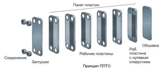
В ППТО рабочие среды могут двигаться в различных направлениях. В ППТО с параллельными потоками различаются два направления: противоточное и прямоточное.
