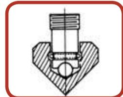
**SWIVEL-TYPE BALL BEARING CONE -**
